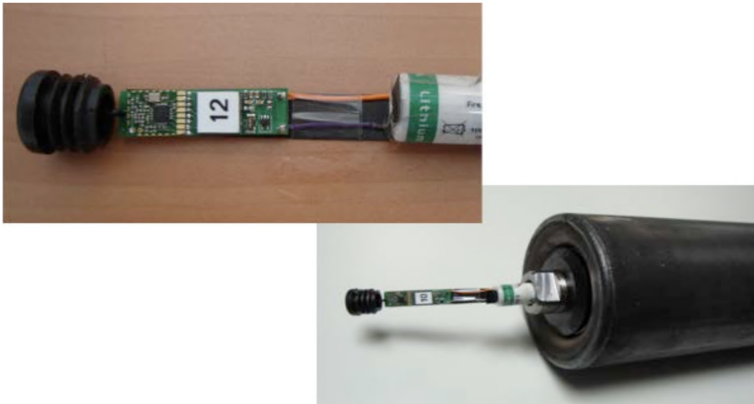
Figura 2.1: Rolo com sensores e RFID. Fonte: (LODEWIJKS et al., 2016) .
