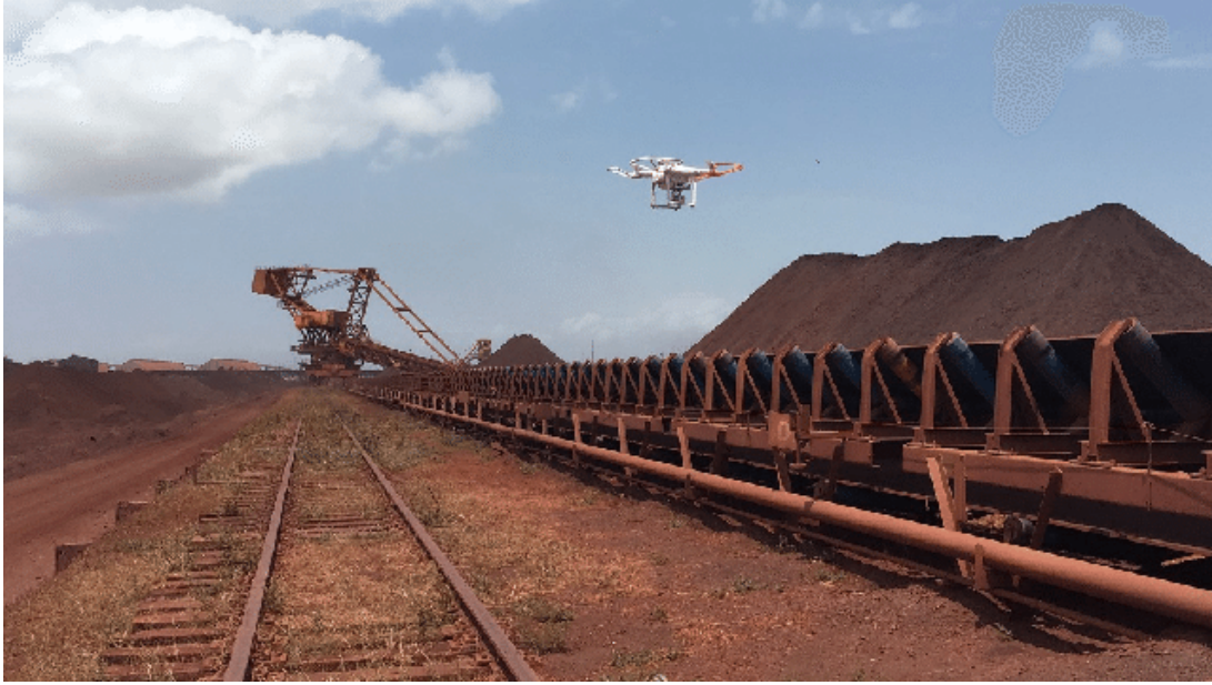
Figura 2.4: VANT realizando captura de imagens térmicas em um TC. Fonte: (NASCIMENTO et al. , 2017b)
