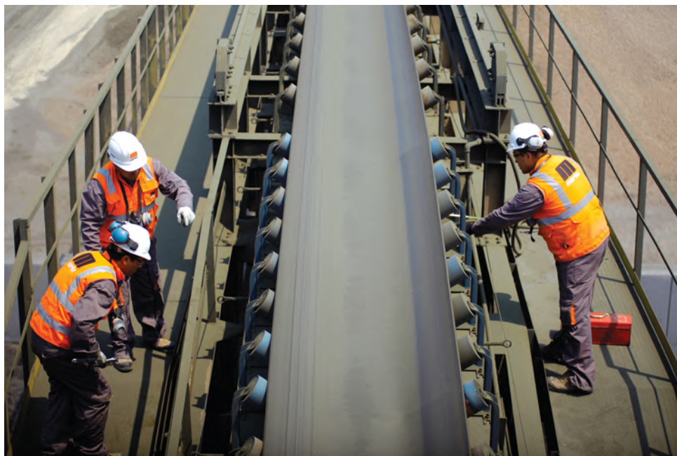
Figura 1.3: Operadores realizando inspeção manual em transportador de correia.
