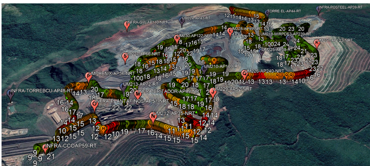
Figura 4.3: Site survey contendo informações referentes a qual célula o cliente estava conectado no momento; cada letra representa uma célula da rede mesh. A funcionalidade de representar a atual conexão foi adicionada sob demanda.
