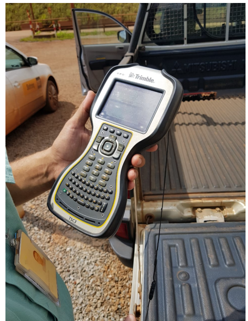
Figura 3.16: O coletor realiza medições e exibe os dados convertidos em diversos formatos de coordenadas.
