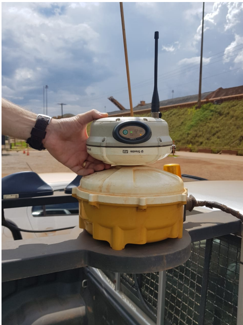
Figura 3.15: Antenas foram colocadas sobrepostas para que as coordenadas fossem comparada.
