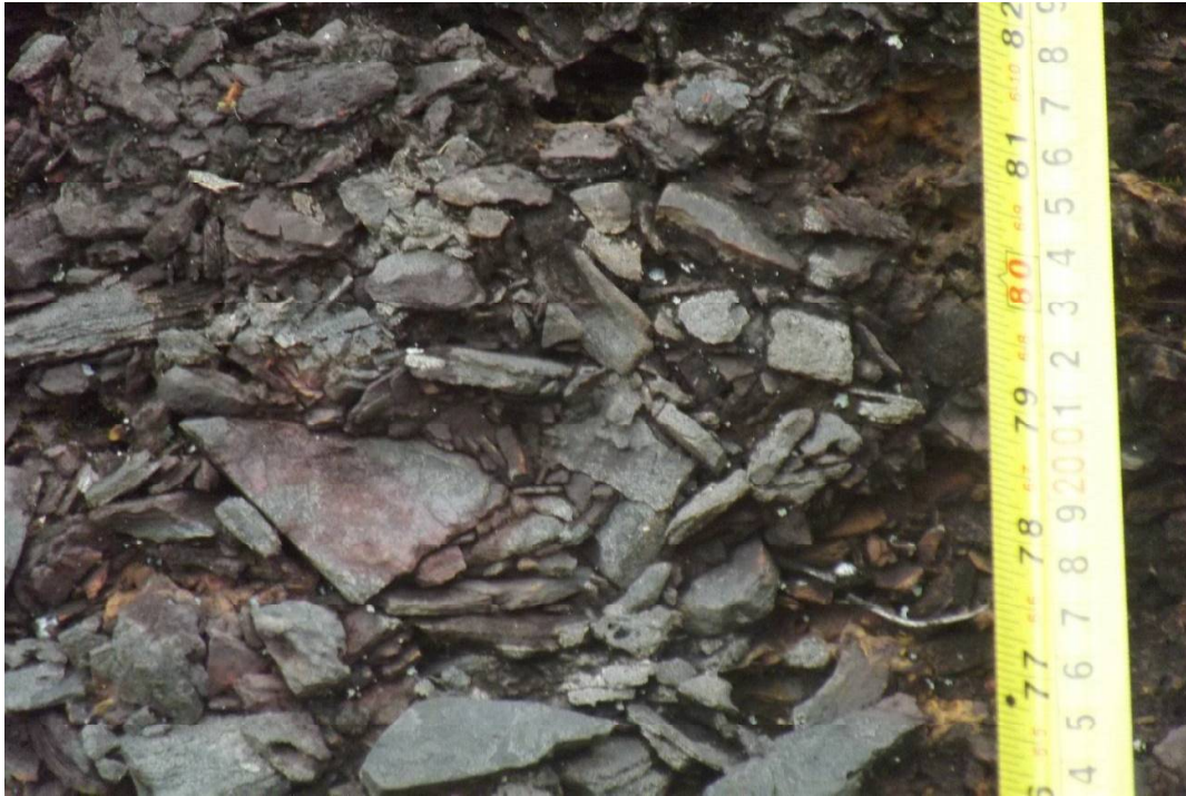
Figure 18: Fragmentos placóides da Fácies Bp com tamanho variando de 2 a 5 centímetros e imbricados entre si sem a presença de matriz.
