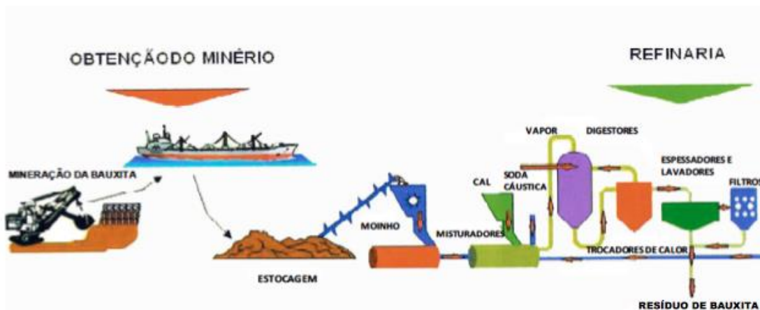
Figura 2 Fluxograma do processo Bayer Fonte: Fortes et al. (2006).
